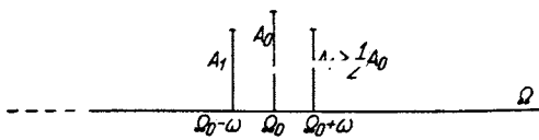
Rys. 5.7. Fala zmodulowana w amplitudzie dla m > 1 i poddana filtracji
